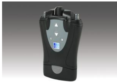
Rádio portátil auricular/fone de mão HSE 6000 e encriptador de ICS
